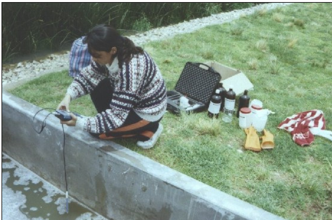
Figura 20: Medición in situ del pH, del potencial mV y de la temperatura en las cajas de de aireación. En el segundo plano se reconoce las distintas botellas de muestreo y una caja con el kit para la determinación de oxígeno disuelto durante el programa de investigación.
