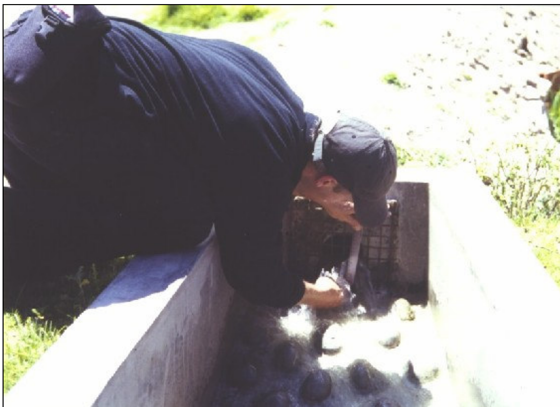
Figura 19: Medición de la altura de agua en la tubería de conexión al sistema principal y de distribución entre las distintas celdas de purificación para la computación de los correspondientes caudales durante el programa de investigación.
